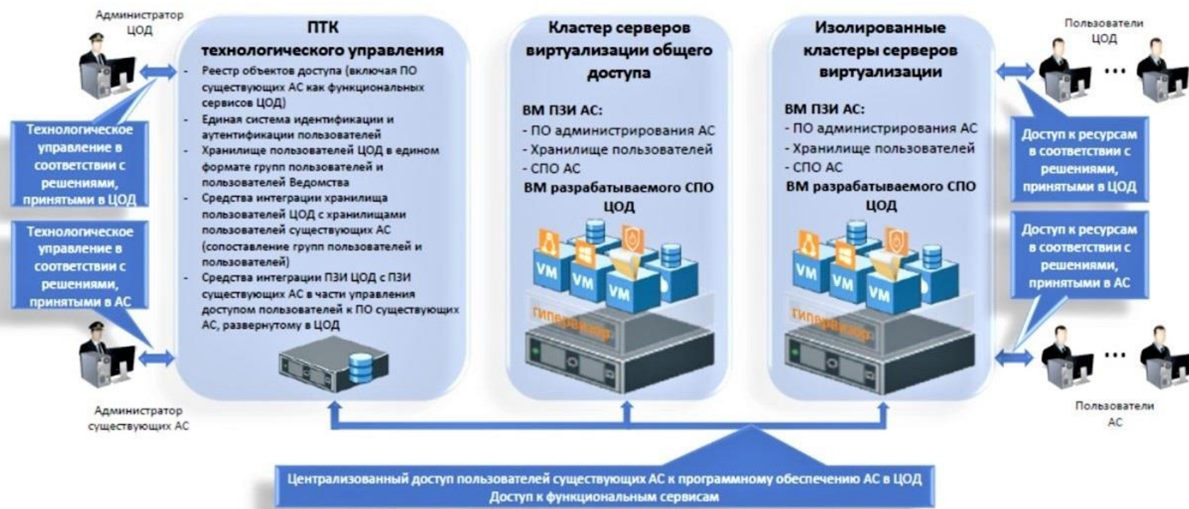
Рисунок 11 - Интеграция подсистем защиты информации существующих АС в подсистему защиты информации ЦОД
