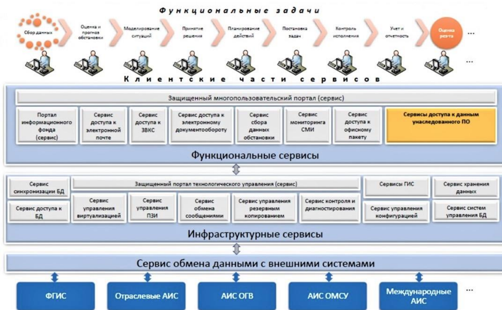
Рисунок 5 - Сервис-ориентированная программная архитектура ЦОД
